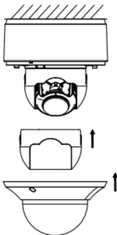
图2-25 安装透明罩
