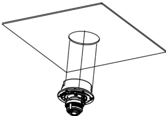
图2-17 安装摄像机球体
