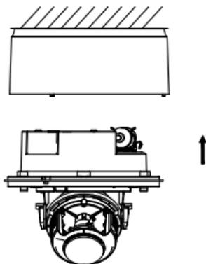
图2-23 固定摄像机球体
