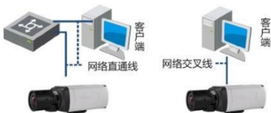
图3-1 连接示意图
