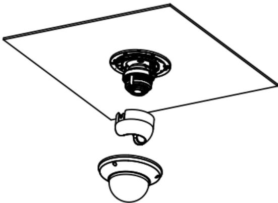
图2-19 安装摄像机组件
