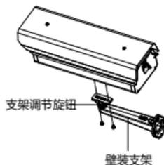
图2-35 安装到壁装支架
